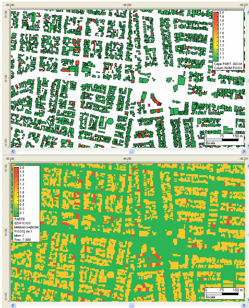
Figura 56 Resultado de rasterización de un shape. Izq. shape original y der. raster generado
