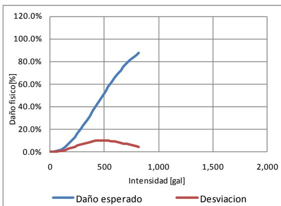
**Figura 3-5** Función de vulnerabilidad sísmica, tipo constructivo W-FLFLB-2
