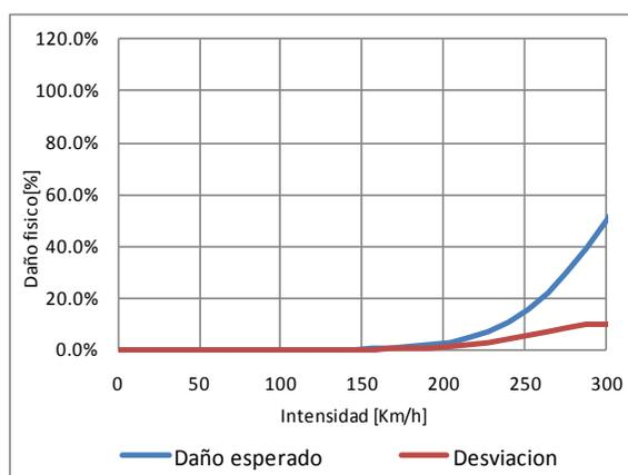
Figura 3-21 Función de vulnerabilidad ante viento, tipo constructivo MR-FLFSB-2
