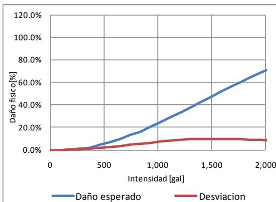
**Figura 3-13** Función de vulnerabilidad sísmica, tipo constructivo PCM-RCFSM-5
