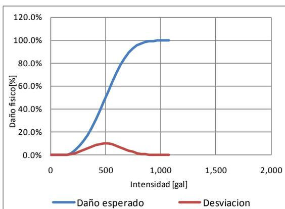
**Figura 3-3** Función de vulnerabilidad sísmica, tipo constructivo MC-FLFSB-2
