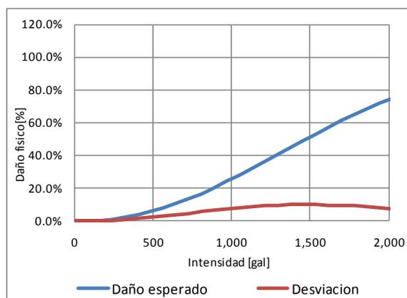
Figura 3-15 Función de vulnerabilidad sísmica, tipo constructivo CPM-RCFSB-2
