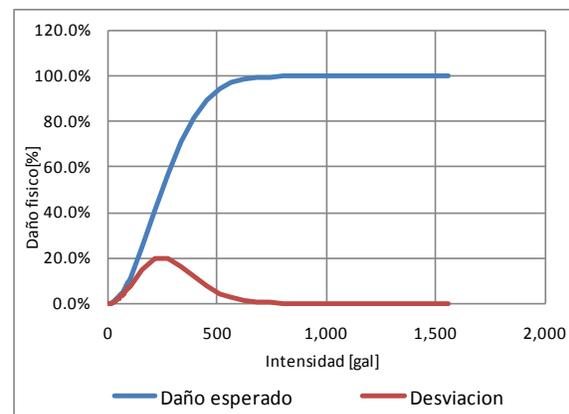
**Figura 3-14** Función de vulnerabilidad sísmica, tipo constructivo R-SLFLB-1
