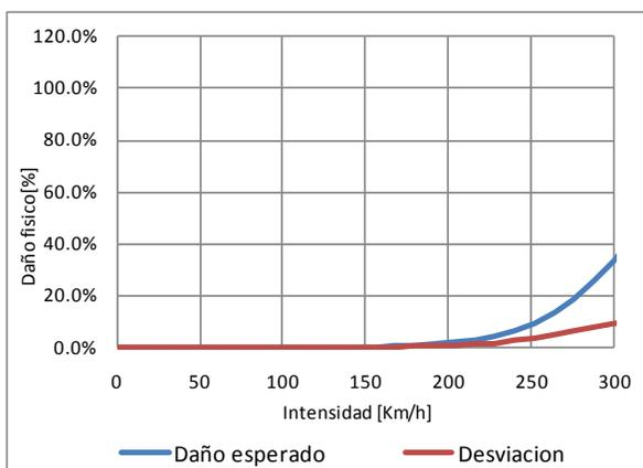
Figura 3-22 Función de vulnerabilidad ante viento, tipo constructivo MR-RLFSB-2
