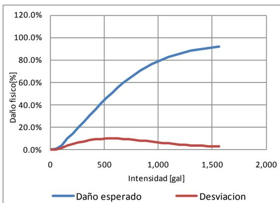
**Figura 3-11** Función de vulnerabilidad sísmica, tipo constructivo PCR-RLFSM-5
