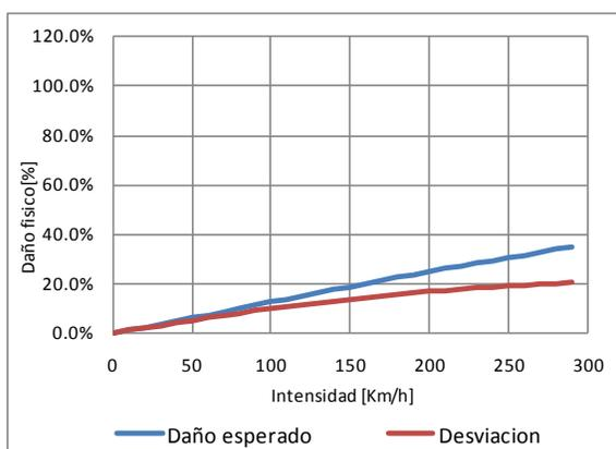
Figura 3-28 Función de vulnerabilidad ante viento, tipo constructivo PCM-RCFSM-5
