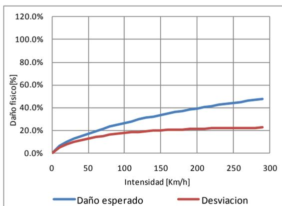
Figura 3-29 Función de vulnerabilidad ante viento, tipo constructivo R-SLFLB-1
