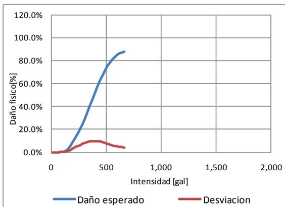
**Figura 3-7** Función de vulnerabilidad sísmica, tipo constructivo MR-RLFSB-2
