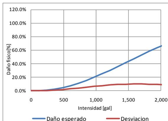
**Figura 3-12** Función de vulnerabilidad sísmica, tipo constructivo PCR-RCFSM-5
