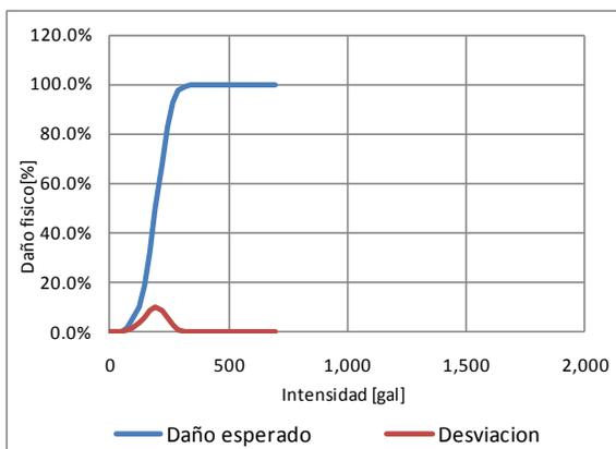
**Figura 3-9** Función de vulnerabilidad sísmica tipo constructivo MS-FLFSB-2
