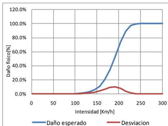
Figura 3-19 Función de vulnerabilidad ante viento, tipo constructivo W-SLFLB-1
