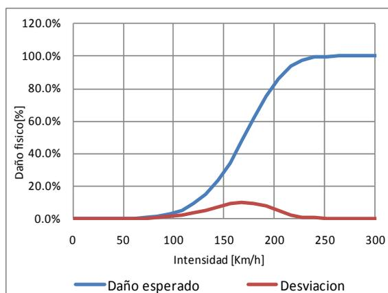
Figura 3-25 Función de vulnerabilidad ante viento, tipo constructivo MS-RLFSB-2
