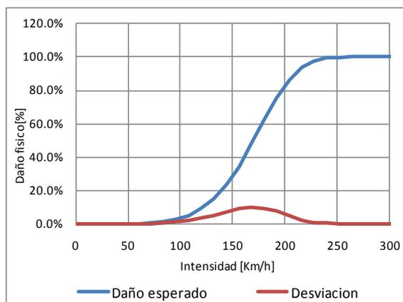
Figura 3-23 Función de vulnerabilidad ante viento, tipo constructivo MS-SLFSB-1
