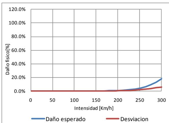
Figura 3-18 Función de vulnerabilidad ante viento, tipo constructivo MC-FLFSB-2
