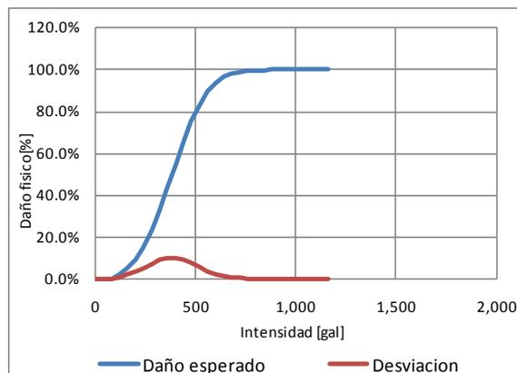
**Figura 3-8** Función de vulnerabilidad sísmica, tipo constructivo MS-SLFSB-1
