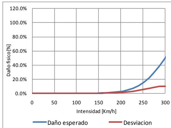
*Figura 3-30 Función de vulnerabilidad ante viento, tipo constructivo CPM-RCFSB-2*
