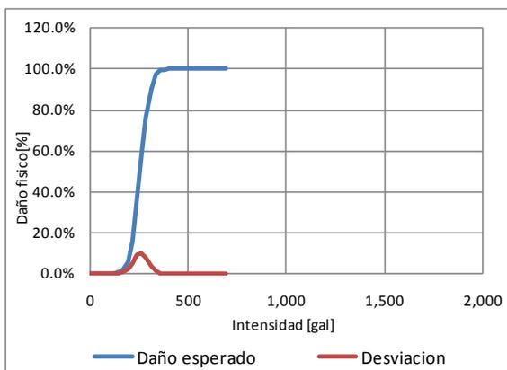
**Figura 3-1** *Función de vulnerabilidad sísmica, tipo constructivo A-SLFSB-1*
