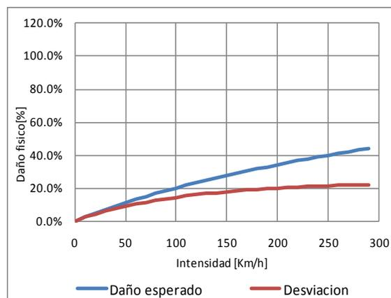
Figura 3-17 Función de vulnerabilidad ante viento, tipo constructivo PCR-RLFLM-5
