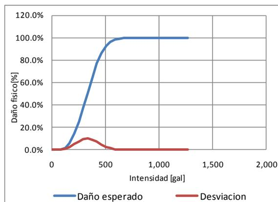
**Figura 3-6** Función de vulnerabilidad sísmica, tipo constructivo MR-FLFSB-2
