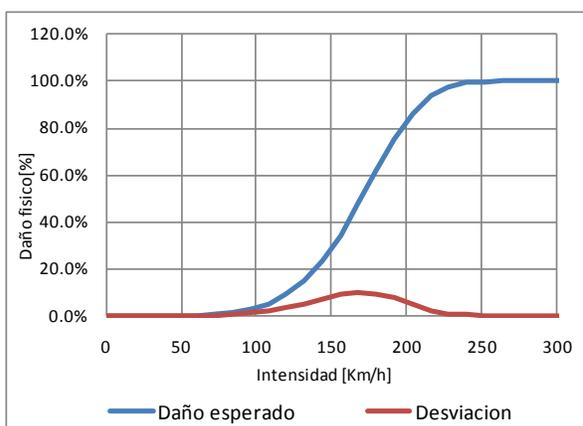
Figura 3-24 Función de vulnerabilidad ante viento, tipo constructivo MS-FLFSB-2
