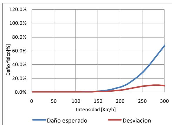
Figura 3-16 Función de vulnerabilidad ante viento, tipo constructivo A-SLFSB-1
