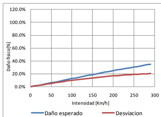
Figura 3-27 Función de vulnerabilidad ante viento, tipo constructivo PCR-RCFSM-5
