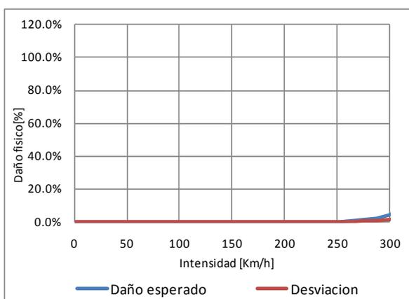
Figura 3-20 Función de vulnerabilidad ante viento, tipo constructivo W-FLFLB-2
