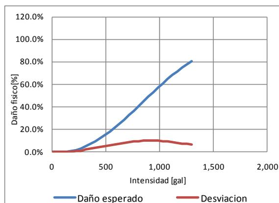
**Figura 3-4** Función de vulnerabilidad sísmica, tipo constructivo W-SLFLB-1
