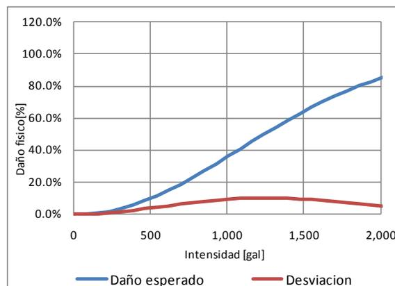
**Figura 3-2** *Función de vulnerabilidad sísmica, tipo constructivo PCR-RLFLM-5*
