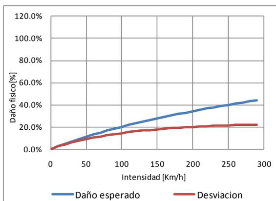
Figura 3-26 Función de vulnerabilidad ante viento, tipo constructivo PCR-RLFSM-5
