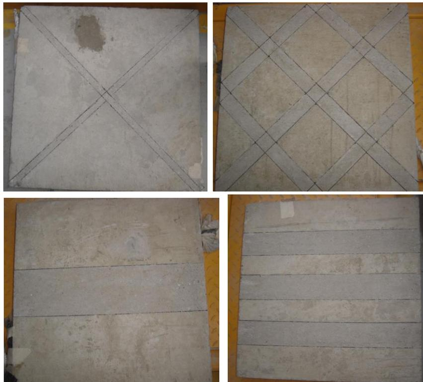
Figura 7: Proceso constructivo, rehabilitación de hormigueros y preparación de los paneles para el pegado de CFRP.
