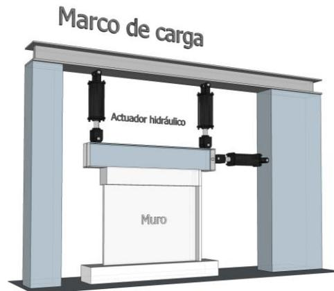
Figura 6: Configuración del ensayo en EPFL.
