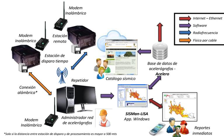
Figura 2: Estructura principal sistema propuesto SISMan LISA V2.0.
