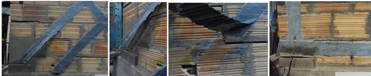
Figura 7: Modos de falla de los especímenes reforzados.
