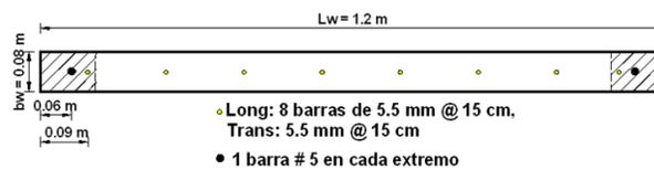
Figura 1: Sección transversal de los muro 1EIA, 2EIA y 3EIA.
