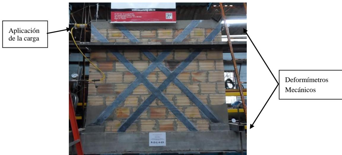
Figura 5: Montaje del ensayo monotónico.
