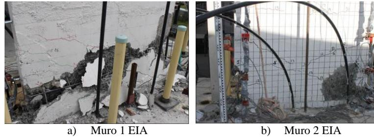
Figura 9: Modo de falla de los muros ensayados en la EIA.
