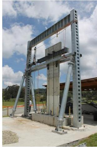
Figura 4: Piso y marco de reacción del laboratorio de estructuras de la EIA sede Palmas.
