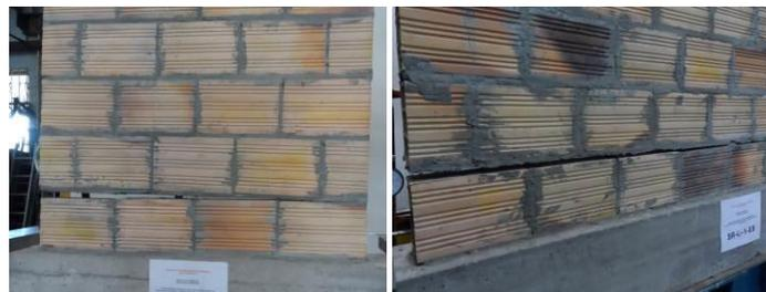
Figura 6: Modos de falla de los especímenes no reforzados.
